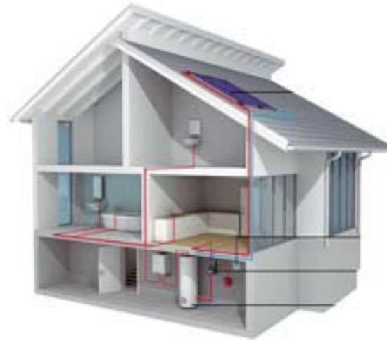
Instalación colectores solares
