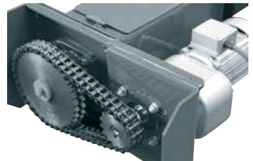
Motores de accionamiento de gran calidad con transmisión por cadena (cadena doble). Momentos de arranque elevados con escaso consumo energético.
