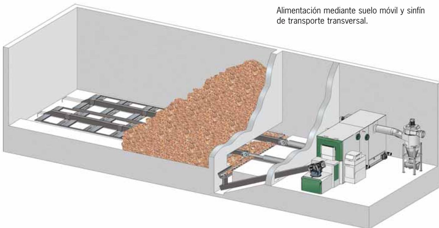
Alimentación mediante suelo móvil y sinfín de transporte transversal.
